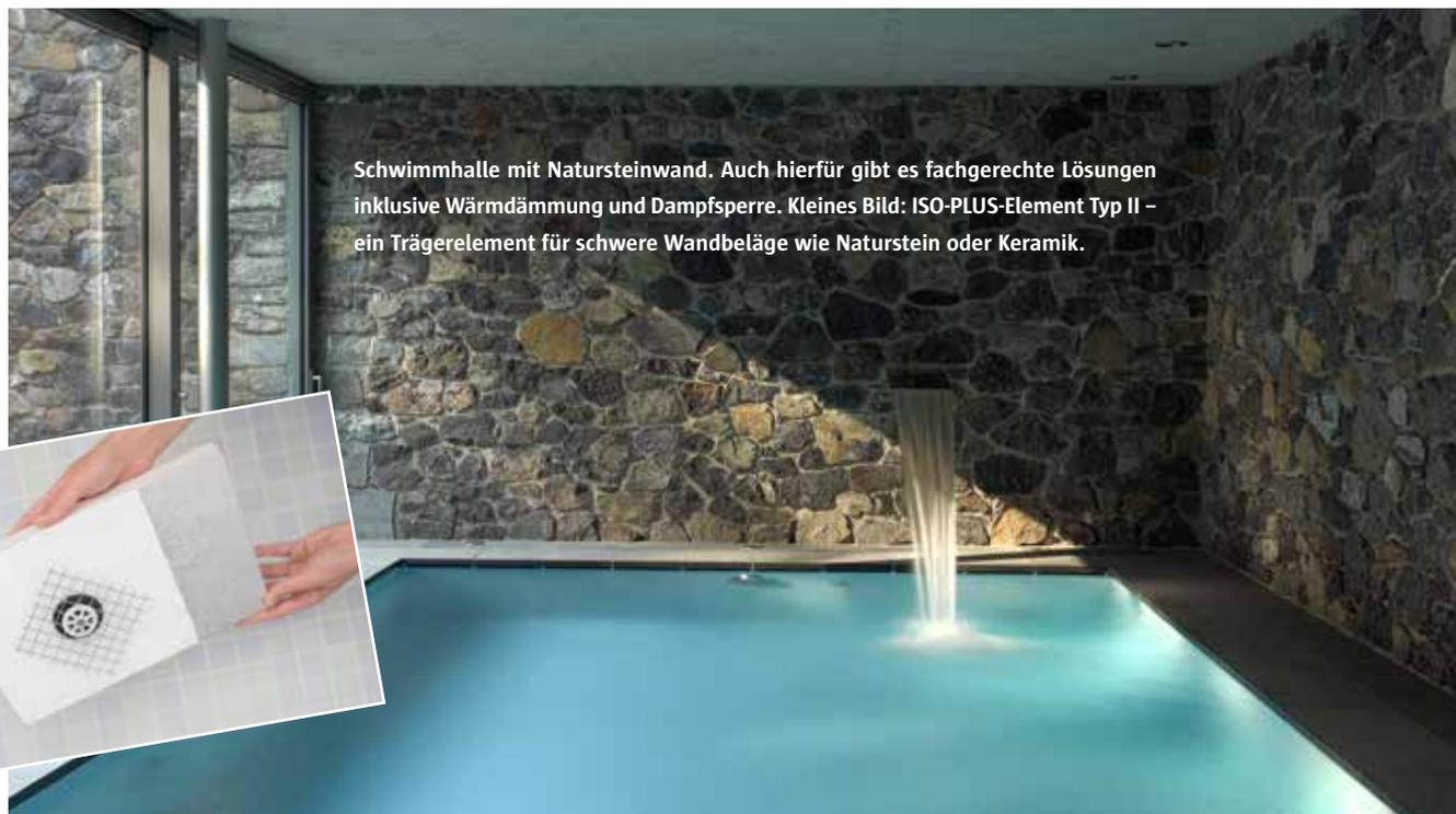
Schwimmhalle mit Natursteinwand. Auch hierfür gibt es fachgerechte Lösungen inklusive Wärmdämmung und Dampfsperre. Kleines Bild: ISO-PLUS-Element Typ II – ein Trägerelement für schwere Wandbeläge wie Naturstein oder Keramik.
