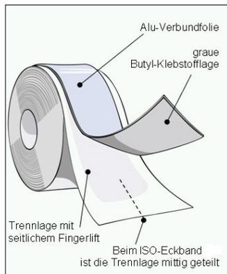
Nach Abziehen der Trennlage wird das Fugenband manuell über die Stoßfugen geklebt und anschließend mit einem planebenen Nahroller angedrückt.
