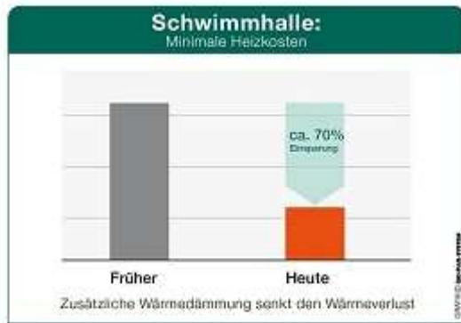
Demnach werden private Schwimmhallen heute mit einem hochwertigen Wärmeschutz versehen, indem sie wie nach Vorgabe außen gedämmt werden und zusätzlich eine Innendämmung mit Alu-Dampfsperre erhalten.
