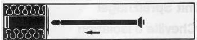
Bei Dübelung in Beton oder festem Mauerwerk **muss** die Spitze des Kunststoffnagels abgebrochen werden.
