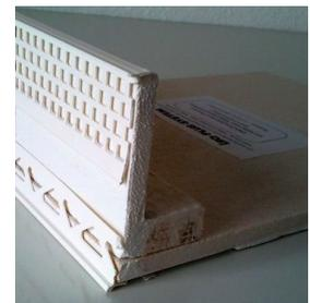
Die Kante kann mit Gewebeamierung gemäß Decken-Beschichtung versehen werden. Als Kanten-Abschluss oben eignet sich das **PVC-Abschluss-Profil FP**. Als Kanten-Abschluss unten eignet sich der **PVC-Winkel** in 2 cm, jeweils mit ca. 2 mm Abzieh-Kante.
