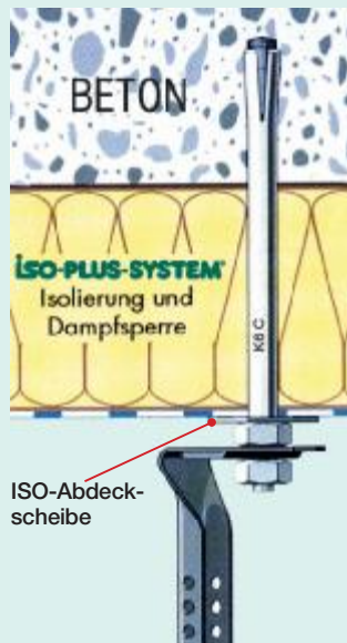
Sichere Verankerung in der Betondecke mit den Kunkel-Dübeln von ISO.
